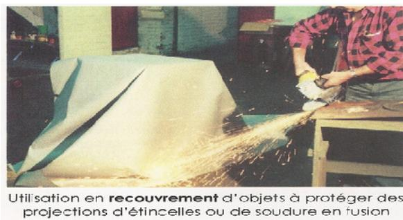
Utilisation en recouvrement d'objets à protéger des projections d'étincelles ou de soudure en fusion
